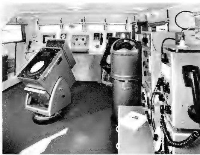
Der Vorführraum auf dem Marconi-Versuchsschiff Elettra III. Links vorn: Argus-Radar mit True-Motion-Anzeige, hinten (von links nach rechts): Bord-sprechanlage, Echolot mit Schreibgerät, Tiefenanzeiger mit direkter Ablesung in Fuß, Lodestar-Peiler, VHF-Funksprechgerät, Chernikoff-Log, Hermes-Radar, ganz rechts vor dem Kompaßgehäuse zwei Schiffssender mit Empfänger
