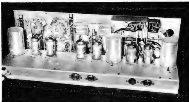
Bild 3. Ansicht des Steuerverstärkers
