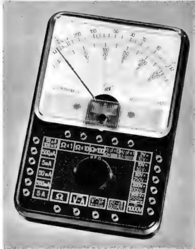
Der elektronische Überlastungsschutz verhindert auch Schäden bei **1000facher** Überlastung des gewählten Bereichs (max. 2500V)
