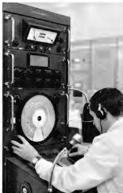
Bild 3. Telefunken-Sichtpeiler in der Meß- und Empfangsstation Bockhake der Deutschen Welle. Die gemessene Einfallsrichtung wird auch zur Einstellung der Antennenrichtcharakteristik benutzt
