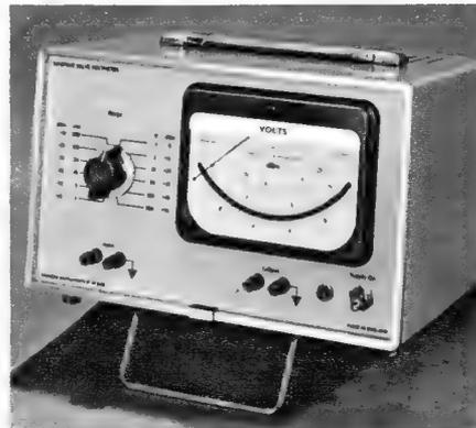
Bild 2. Ansicht des Verstärker-Voltmeters TF 2600 von Marconi Instruments
