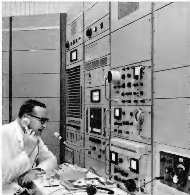
Bild 2. Einer der bisher eingerichteten drei Empfangsplätze mit zwei Empfängern, Einseitenbandzusatz, Telegrafiedemulator und Nf-Schaltfeld
